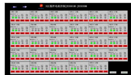
搅拌电机监控画面
